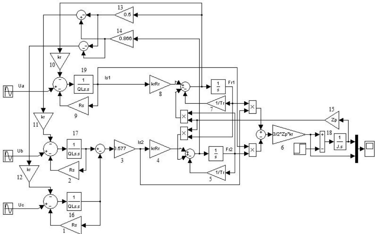
Рис. 1. Структурная схема динамической модели асинхронного двигателя
